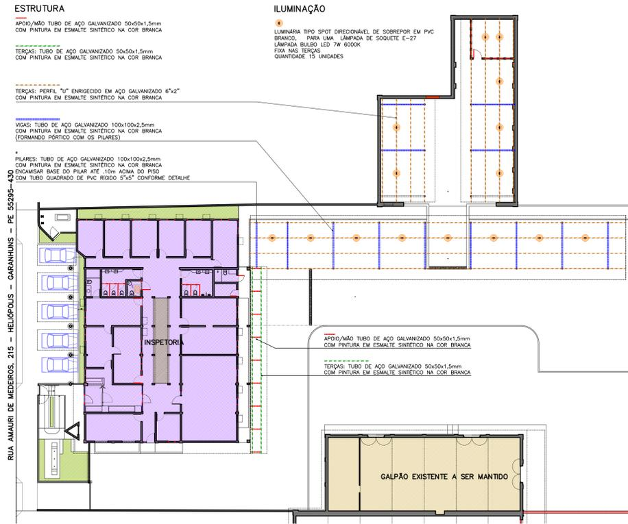
**PLANTA BAIXA** Esquema Estrutural e Iluminação
