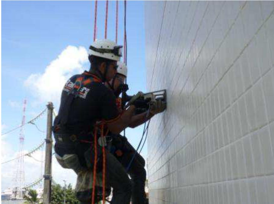
Figura 12-Execução do ensaio de aderência.
